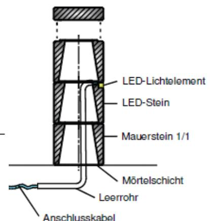
Für die Befestigung und Ausrichtung des LED—Mauer Leuchtelements muss die aus Kunststoff bestehende Ober- und Unterseite mit einem geeigneten Kleber an beiden Flächen, an den Betonteilen angeklebt werden.
